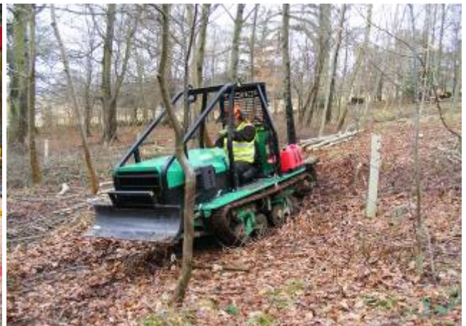
Figure 4 Mini OxTrac Skidder 2 tonne un-laden weight
